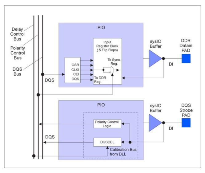
Figure 4 - Block Diagram of Dedicated DQS Circuitry
