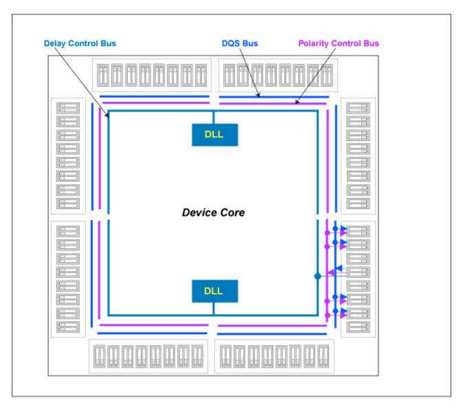
Figure 5 - DLL Calibration Bus and DQS/DQS Transition Distribution
