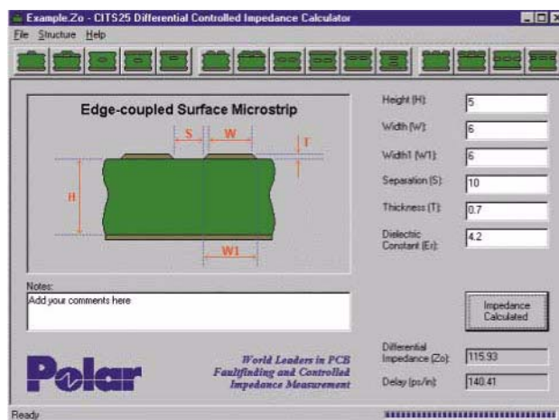
图 8: 采用 Polar CITS25 阻抗计算工具计算差分阻抗（微带方式）的示例
